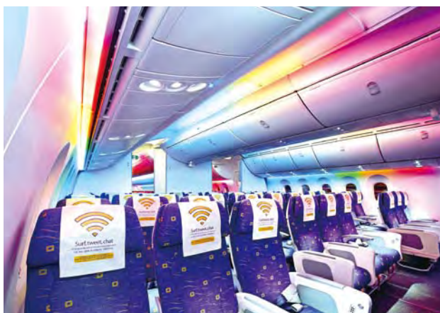
▲酷航B787運用LED燈，模擬白日、夕陽、黑夜等情境，讓旅客在飛行中感受更加舒適、減緩時差。
