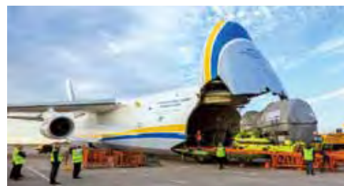
▼安托諾夫航空可將機頭打開，完整放入貨物不須拆解。
