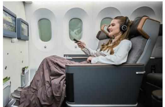
▲長榮航空第4代豪華經濟艙座椅後傾採用搖籃式座椅傾斜技術，椅背以5英吋後傾實現等同於8英吋的舒適角度，使後座旅客空間更顯充裕。
