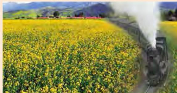
四川隸為被譽為「工業活化石」的嘉陽蒸汽小火車迎「春運」，海內外遊客乘坐火車暢遊花海，青山花海間一片歡聲笑語。嘉陽蒸汽小火車軌距僅762毫米，採用人工加煤、制動、扳道、掛鉤等原始操作方式，是世界上唯一還在正常運行的客運窄軌蒸汽小火車。
