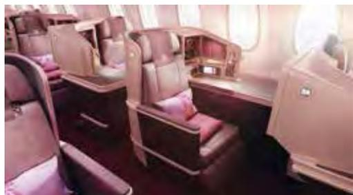
▲吉祥航空B787商務艙配備Thomson Vantage XL全平躺座椅以及18英寸松下最新一代機上娛樂系統。
