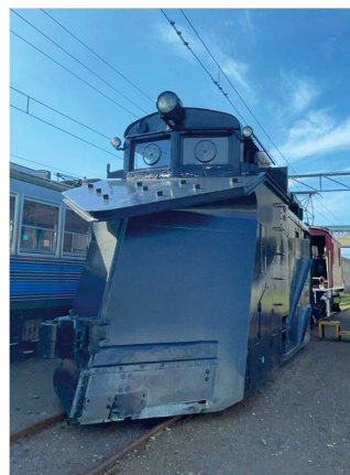
▲外型帥氣的「犁式除雪車」專門用來清除鐵軌積雪，是冬季最佳幫手。
